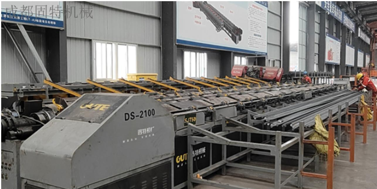
自主研发的集电气、液压、气动为一体的产品，可完成钢筋直径12-50mm，强度hrb335、hrb400、hrb500的锯切、剥肋、套丝的功能，实现了三个工位的在线连续生产，减少了物料二次落地，降低了劳动强度，具有锯切---、套丝、节能省料、操作简单等特点。产品特点：1. 送料辊道采用plc控制，移动式辊道加固定挡板定尺，精度高。2. 螺纹钢金属带锯床，具有切削---、节能省料、操作简单等特点。3. 本产品原料存储架采用大吨位存储，并可与棒材自动上料机配合使用，实现上一个循环尚未结束时即可进行下一步配料，以节省喂料周期。4. 全自动送料辊道，避免原料的二次搬运，钢筋的输送、翻转、传递等全部由机械完成，大幅度提高了效率。5. 钢筋输送滚采用V型耐磨辊进行，具有耐磨、减噪音、---等特点。6. 剥肋、滚丝主机头实现了气缸夹紧、送进功效，提高了剥肋、滚丝效率。
